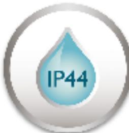
Toto venkovní svítidlo Philips je speciálně navrženo pro vlnité venkovní prostředí a prošlo řadou různých testů, které zajistily jeho odolnost. Stupeň ochrany IP pošluji dva údaje: první označuje stupně ochrany proti pracovi a druhý proti vodě. Svítidlo je zkonstruováno s ochranou IP44: je chráněno proti stříkající vodě, jedná se o výrobek, který je nejblíže ji a nejvhodnější pro všeobecné venkovní použití.
